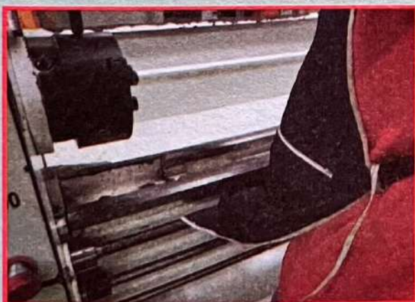
รูปที่ 1.14 เสื้อฝึกรงานมีชายผ้าหลุดเข้าไปติดกับเพลาเกลียววนา เป็นการแต่งกายที่ไม่รัดกุม
