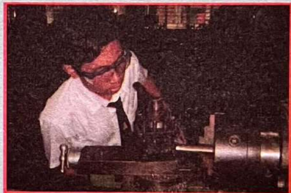
รูปที่ 1.13 ผู้ปฏิบัติงานต้องไม่ผูกเนกไท่ไปปฏิบัติงาน เป็นการแต่งกายที่ไม่รัดกุม
