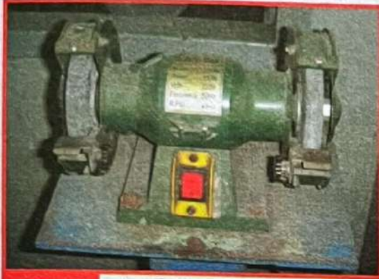
รูปที่ 1.20 เครื่องเจียรในไม่มีกระจกนิรภัย
